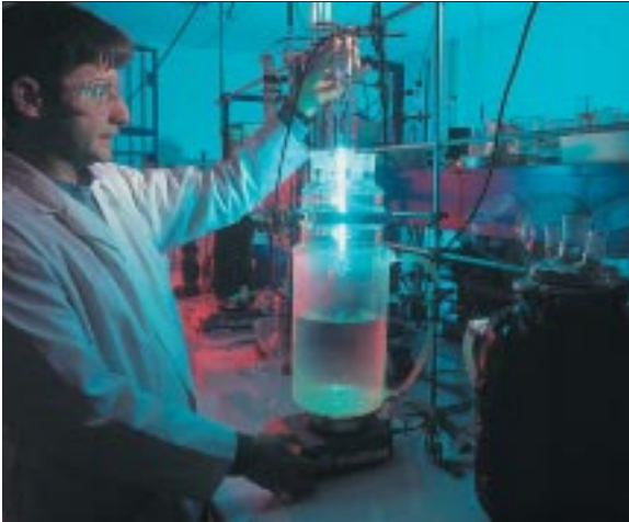
Chercheur réalisant une expérience de photolyse par rayonnement ultraviolet en solution aqueuse. Le chercheur introduit la lampe dans le réacteur contenant la solution à traiter. L'objectif de la recherche est l'élimination de polluants de l'eau, organiques ou minéraux souvent présents à l'état de trace. > photo CNRS
